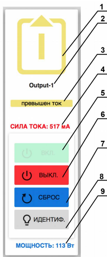
Рисунок 4.2.9. Управление состоянием выводов в режиме управления (Control mode).
