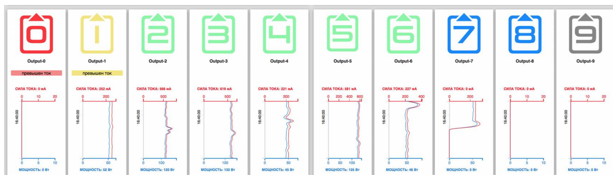
Рисунок 4.2.3. Пример цветовой индикации на панели управления web-интерфейса RPCM — Dashboard для выводов.
