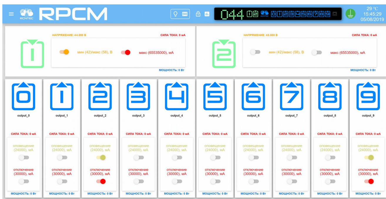
Рисунок 4.2.15. Панель управления Dashboard в режиме вызова настройки демонстрации установленных лимитов RPCM DC ATS 76A с включёнными тумблерами на вводах и выводе.
