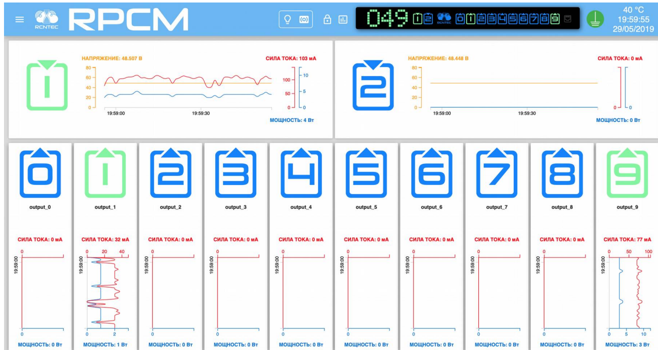
Рисунок 4.2.2. Панель управления web-интерфейса RPCM DC ATS 76A — Dashboard в режиме просмотра View Mode.
