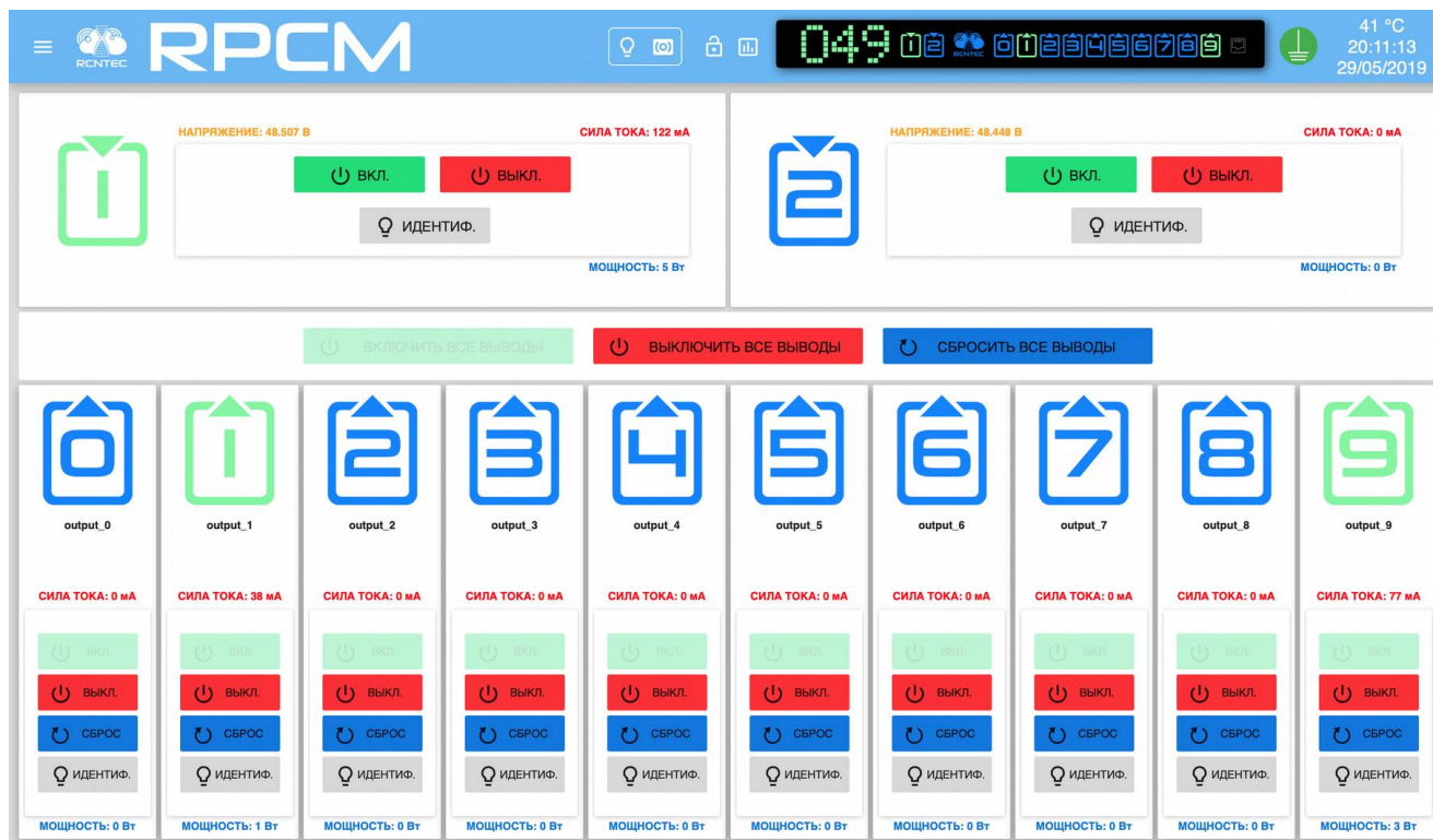
Рисунок 4.2.7. Панель управления web-интерфейса RPCM — Dashboard в режиме управления Control Mode.
