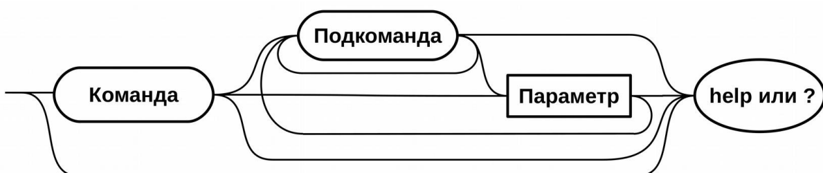
Рисунок 4.3.3. Общая схема получения справки.
